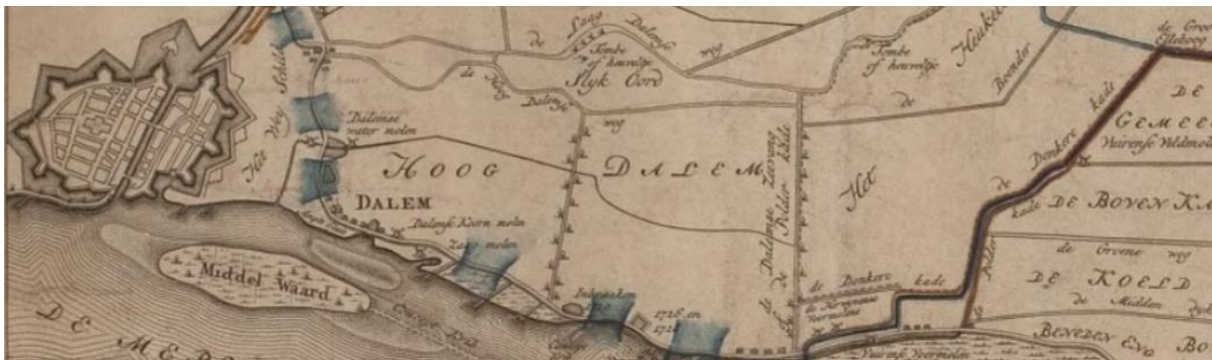
Figuur 104. Dijkdoorbraken bij Dalem in 1729 ter plaatse van de overlaten op de kaart van de Tielerwaard uit 1787. Bij de pijl staat de Ambtssluis.
