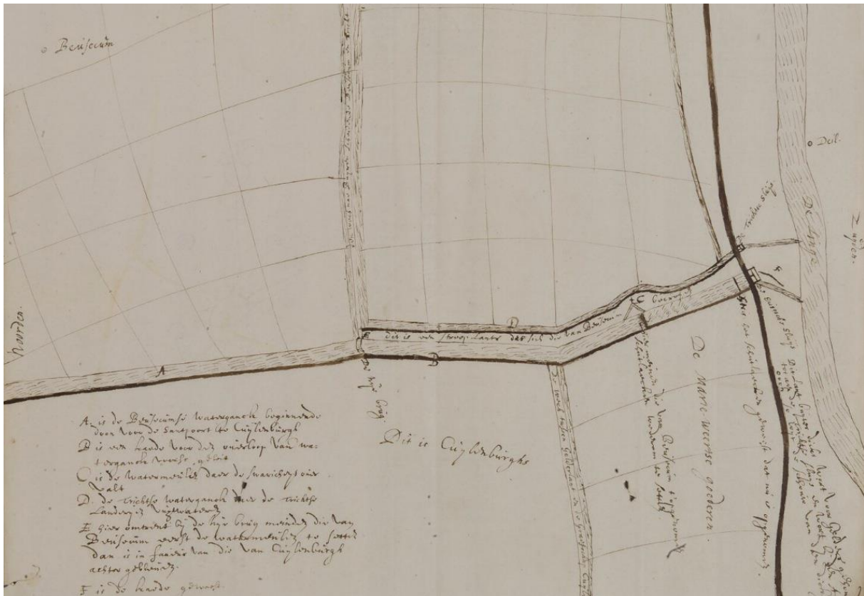
Figuur 7. Met behulp van de Eustse sluis (de Neust) tussen de Mariënwaard en Tricht werd het water uit de noordoostelijke komgebieden op de Linge afgewaterd. Situatie in 1629. Het noorden is links (bron: Gelders Archief, toegang 1510, inventarisnr. 0124-1320A).
