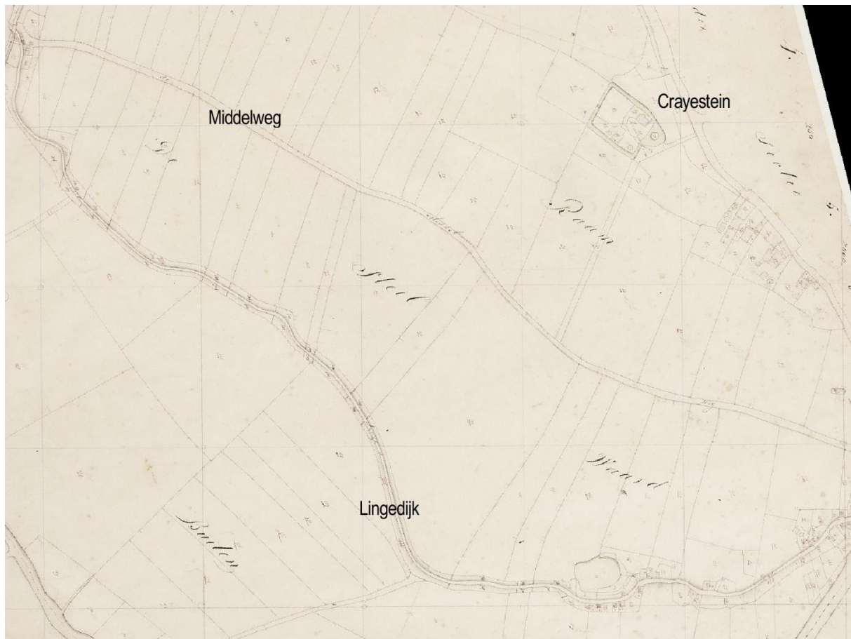
Figuur 5. Binnen de Steilwaard, ten westen van Tricht, werd een strookvormige verkaveling haaks op de hoogtelijnen aangelegd. Hierdoor kwam een goede afwatering tot stand en bezat iedere eigenaar een hoog en een laag deel (bron: kadastraal minuutplan Buurmalsen, sectie E, blad 1, 1832).
